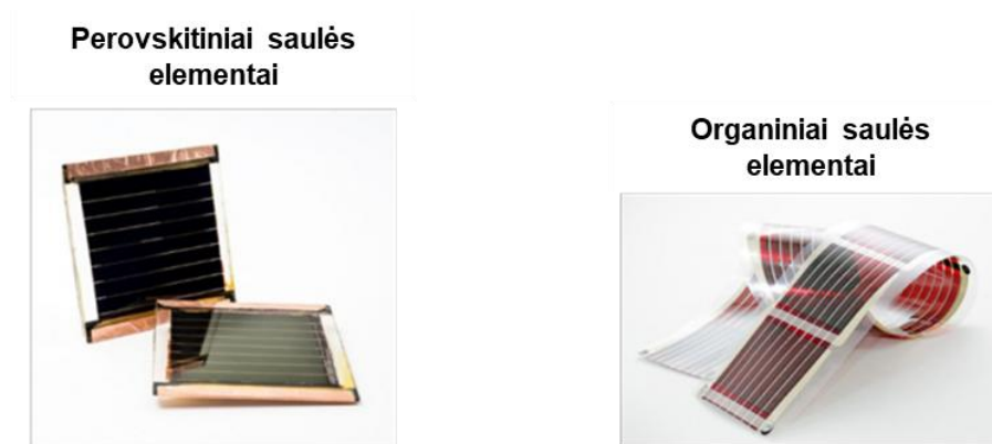
8 pav. Trečiosios kartos saulės elementų pavyzdžiai (perovskitiniai saulės elementai (kairėje), organiniai saulės elementai (dešinėje)) [99]
